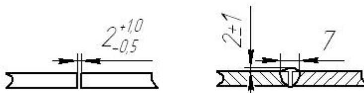
Р и с. 2. Эскиз стыкового сварного соединения а – подготовка кромок; б – параметры шва
